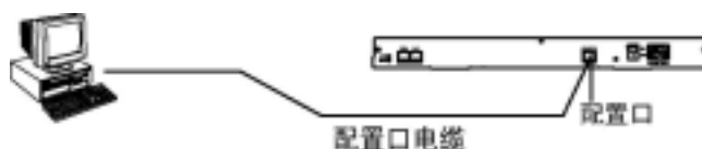
图 4-1 通过 Console 口搭建本地配置环境
